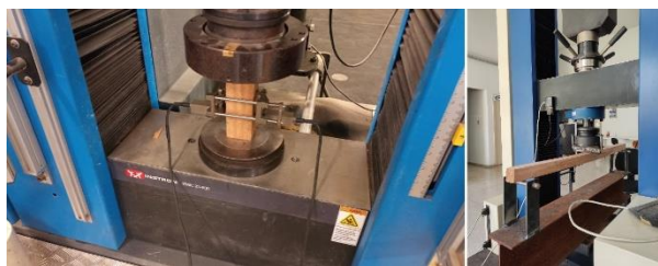
Figura 1. Prensa universal de ensaio EMIC 23-600 (à esquerda) e EMIC 300, adaptada com dispositivo para ensaio de flexão (à direita).
