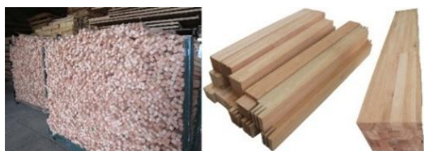
Figura 3. Resíduos do desdobramento (esquerda), fragmentos cortados e com joint-finger (centro) e peça de MFC (direita). Fonte: os Autores (remoção de fundo via IA Gemini).
