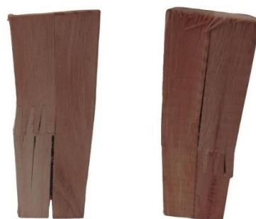
Figura 5. Aspecto dos corpos de prova após o ensaio de compressão. Fonte: os Autores (remoção de fundo via PicWich, versão gratuita).
