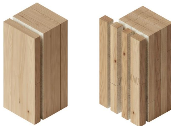
Figura 4. Representação dos processos de produção da MLC, composta por lamelas (à esquerda) e da MFC, formada por lamelas de fragmentos colados e posteriormente unidas por nova colagem (à direita). Fonte: os Autores (com auxílio da IA - Gemini e ChatGPT).
