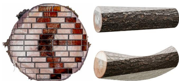
Figura 2. Representação esquemática do desdobro de tora, evidenciando as regiões sujeitas à fragmentação em razão de defeitos (trincas e rachaduras), redução dimensional das seções por conicidade ou encurvamento natural do tronco. Fonte: os Autores (com uso da IA - Gemini e ChatGPT).
