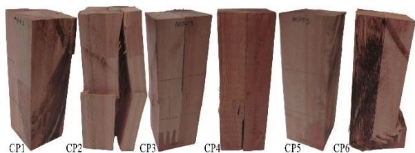
Figura 6. Aspecto dos corpos de prova após ensaio de compressão para MOE. Fonte: os Autores (remoção de fundo via PicWich, versão gratuita).
