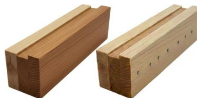
Figura 5. Esquerda: três peças de madeira simplesmente justapostas. Direita: Madeira composta, constituída por três peças de madeira unidas por pino. Fonte: Produzidas pelos autores com auxílio da IA (Gemini e ChatGpt)
