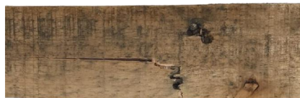
Figura 10. Imagem ampliada da região de falha de um corpo de prova de madeira composta pinada de E. urograndis . Fonte: Acervo dos autores.
