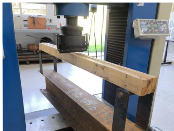
Figura 7. Prensa EMIC 300 utilizada nos ensaios a flexão estática, com dispositivo de três cutelos acoplado. Fonte: Acervo dos autores.
