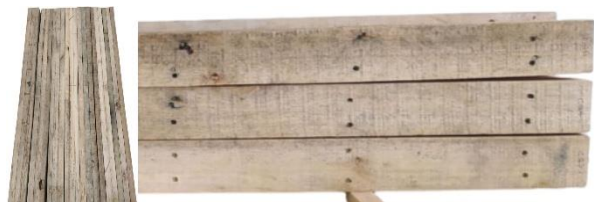
Figura 6. Madeira composta pinada: Vista superior (esquerda) e corte ampliado da vista lateral (direita). Fonte: Composição de fotos do acervo dos autores com remoção de fundo.
