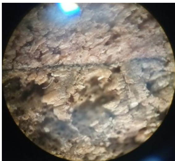
Figura 11. Imagem ampliada em lupa com capacidade de aumento de 40x, onde é possível observar a linha de cola da MLC. Fonte: dos autores
