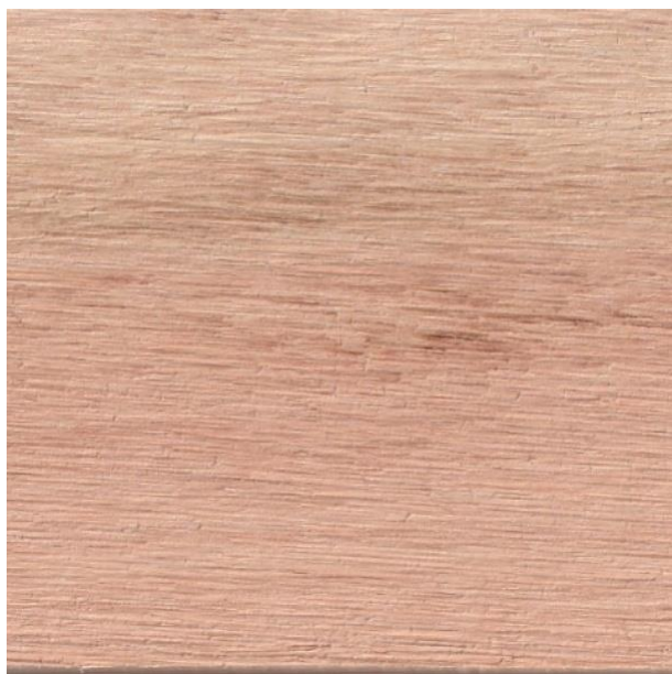
Figura 10.- Textura da MLC de E. urograndis : imagem obtida em microscópio com capacidade de ampliação de 1600x que mostra a rugosidade da face da madeira. Fonte: Dos autores.
