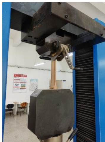
Figura 5. Prensa EMIC 300 com dispositivo para ensaio de tração. Fonte: Dos autores.
