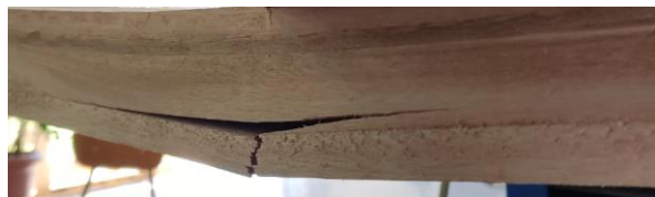
Figura 12. Recorte de imagem no ponto de ruptura da madeira de MLC ensaiada a flexão. Fonte: Dos autores.
