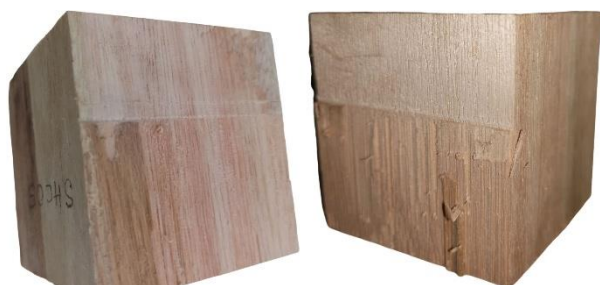
Figura 15. Testemunhos de corpos de prova ensaiados a cisalhamento na linha de cola da MLC de E. urograndis . Fonte: Dos autores.
