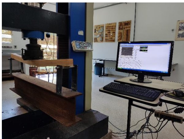
Figura 4. Prensa EMIC 300 com dispositivo para ensaio a flexão estática. Fonte: Dos autores.
