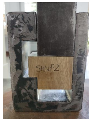
Figura 6. Dispositivo acoplado a prensa EMIC 300 para ensaio de cisalhamento. Fonte: Dos autores.
