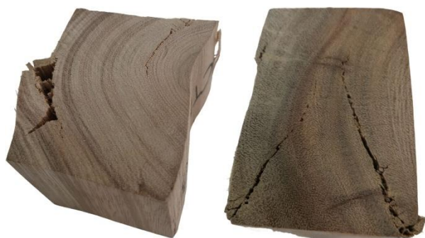
Figura 11. Corpos de prova de C. citriodora ensaiados a compressão normal, onde se observa as linhas de ruptura acompanhando ou tangenciando os anéis de crescimento da madeira. Fonte: Dos autores.
