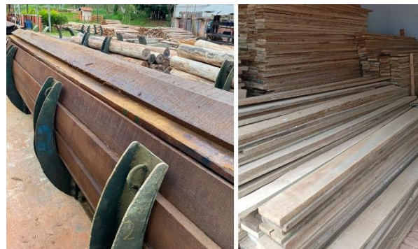
Figura 2. Madeira de C. citriodora tratada para uso em instalações rurais (esquerda) e sem tratamento (direita). Fonte: 11 .
