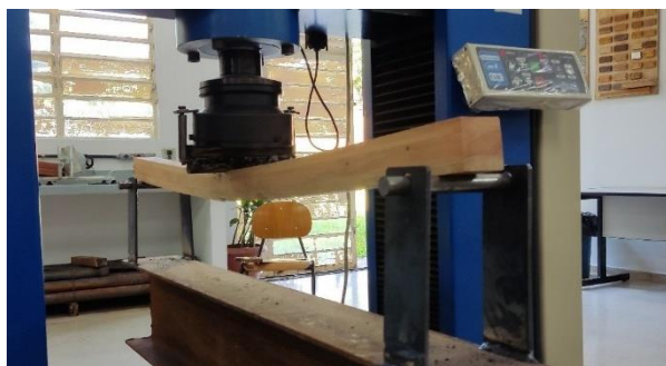
Figura 6. Prensa EMIC 300 com dispositivo para ensaio a flexão estática. Fonte: Dos autores.
