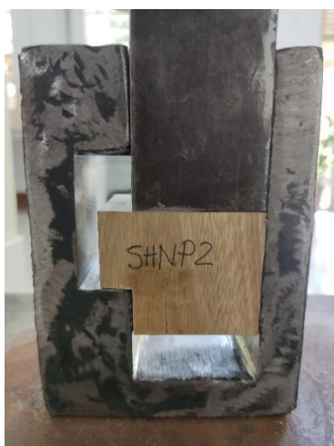
Figura 7. Dispositivo acoplado a prensa EMIC 300 para ensaio de cisalhamento. Fonte: Dos autores.
