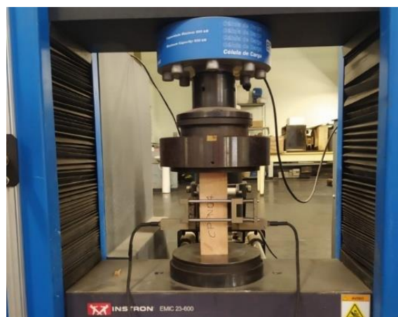
Figura 5. Prensa EMIC 23-600 utilizada nos ensaios resistência à compressão e de rigidez. Fonte: Dos autores.
