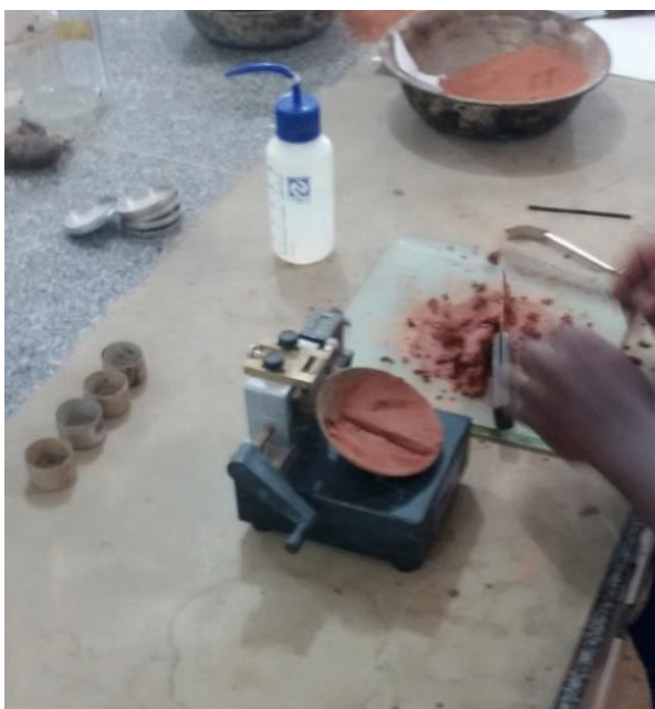
Figura 4. Ensaio de Limite de liquidez. Fonte: Autores
