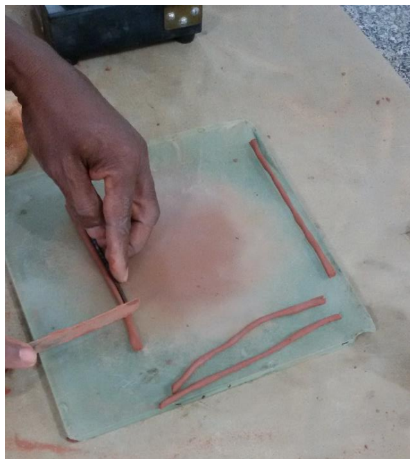
Figura 5. Ensaio de Limite de plasticidade. Fonte: Autores
