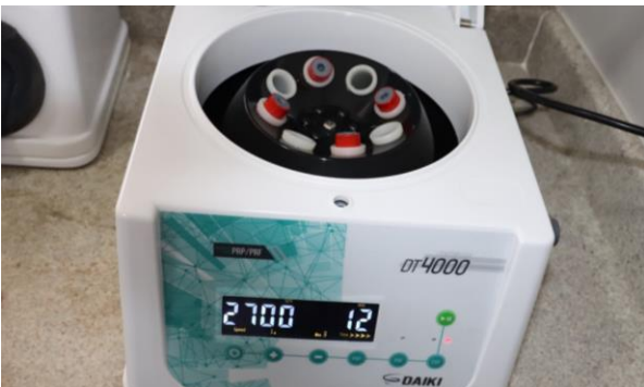
Figura 4. Tubos de sangue posicionados em centrífuga com programação de 2700 rpm por 12 minutos.
