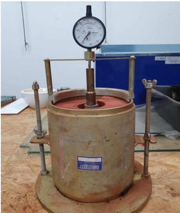
**Figura 4.** Ensaio de Índice de Suporte Califórnia (ISC). **Fonte:** De autoria própria.
