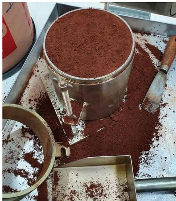
**Figura 2.** Ensaio de Compactação Proctor Normal. **Fonte:** De autoria própria.
