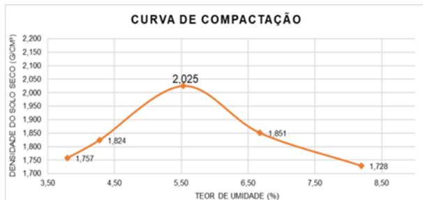
Figura 11. Curva de compactação. Amostra nº 01. Fonte: De autoria própria.
