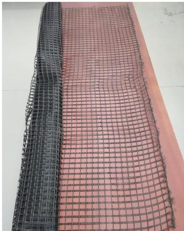
Figura 8. Geogrelha WG40S utilizada. Fonte: De autoria própria.
