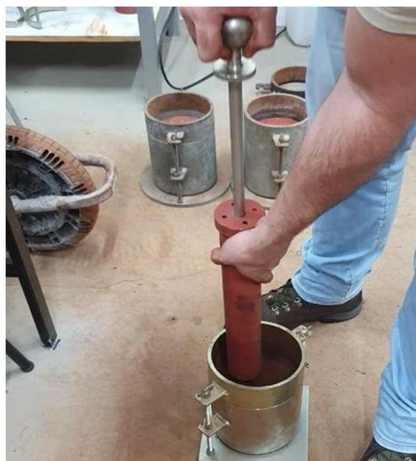
**Figura 3.** Ensaio de Compactação Proctor Normal. **Fonte:** De autoria própria.
