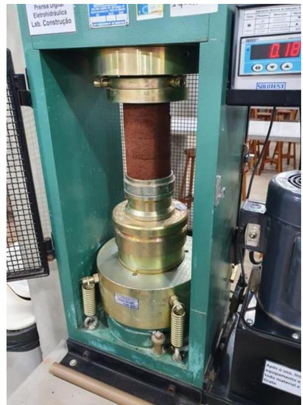
**Figura 6.** Ensaio de Índice de Compressão Axial Simples. **Fonte:** De autoria própria.
