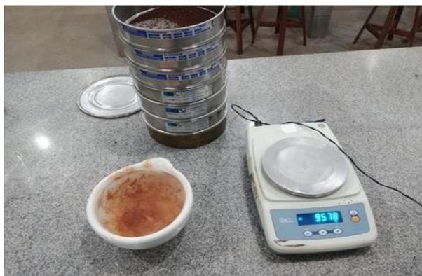
**Figura 1.** Ensaio de Classificação Granulométrica. **Fonte:** De autoriaprópria.
