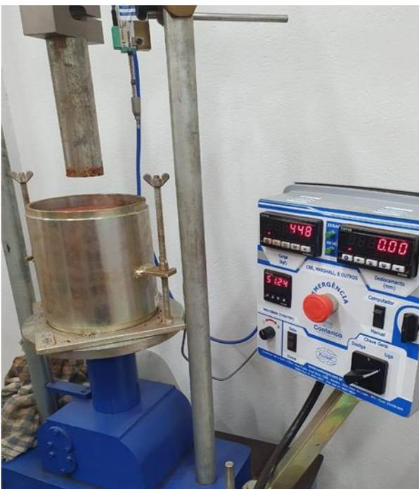
**Figura 5.** Ensaio de Índice de Suporte Califórnia (ISC). **Fonte:** De autoria própria.
