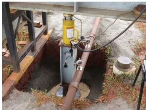
Figura 4. Imagem superior: Vista frontal do processo de inundação do subleito; Imagem inferior: vista frontal do subleito sendo ensaiado. Fonte: adaptada de Freitas (2020) 10 .
