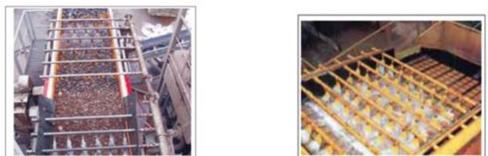
Figura 4. Peneiramento a úmido. Fonte: Bergerman, 2015<sup>25</sup>.
