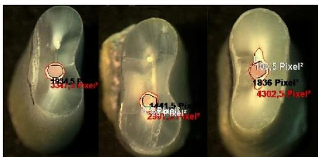
**Figura 3.** Dentes preenchidos com cimento Bio-C Sealer, fotografados com uma lupa estereoscópica em um aumento de 10x.
