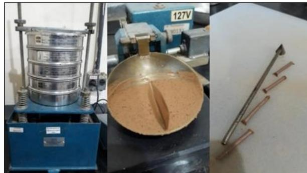
**Figura 1.** Análise Granulométrica, Delimitação dos Limites de Liquidez e Plasticidade, da esquerda para a direita. **Fonte:** AUTORES/2018.
