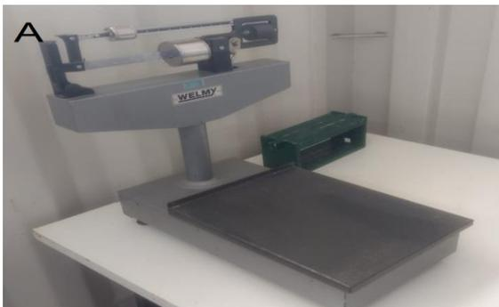
Figura 3. Balança de precisão. Fonte: De autoria própria
