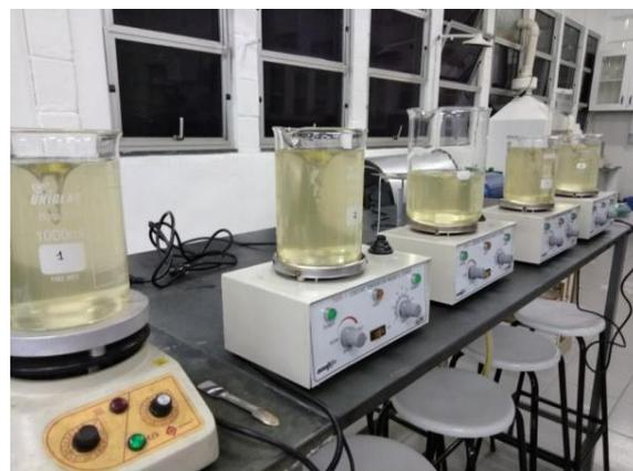
**Figura 3.** Amostras contendo sulfato de alumínio e amido. **Fonte:** Autores, 2018.
