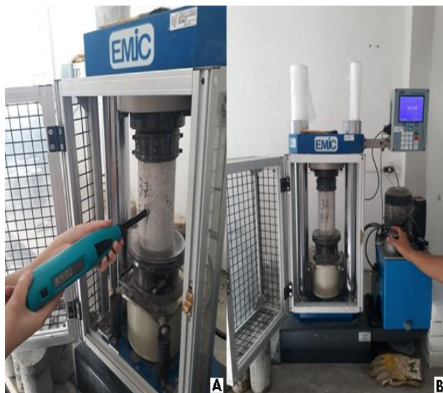
Figura 5. (A) Ensaio de esclerometria em copos de prova. (B) Rompimento dos copos de prova. Fonte: AUTORA, 2018
