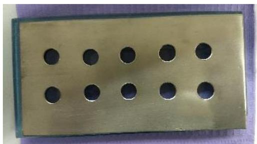
Figura 3. Matriz com 1mm de espessura e com 10 furos de 10mm de diâmetro.
