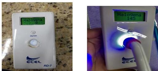
Figura 5. Verificação da passagem de luz no corpo de prova.
