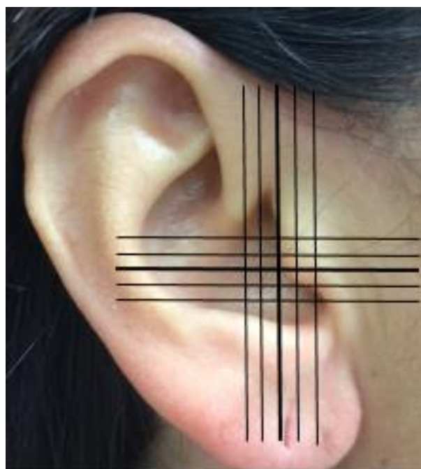
Figura 2. Orelha real com a marcação do ponto central dos pontos de deslocamentos do fone em 5 e 10 mm para frente, para trás, para cima e para baixo. Fonte: os autores.
