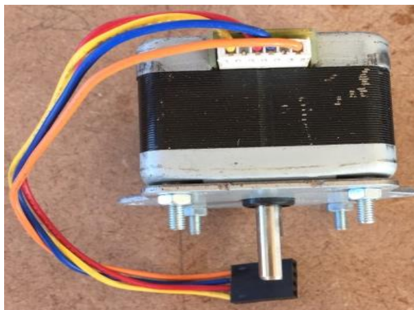
Figura 1. Motor de passo NEMA 17 1 . Fonte: Os Autores.
