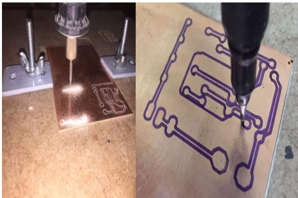
Figura 6. À esquerda usinagem com retirada de material e a direita desempenhando a função de plotter . Fonte: Os Autores.
