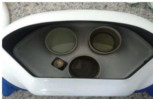
Figura 1. Simulação do teste da moeda. Filme radiográfico no interior da câmara escura, porém com a tampa aberta para visualização.
