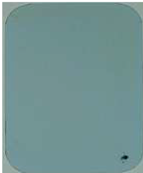
Figura 3. Filme radiográfico sem apresentar velamento. Indicativo de câmara sem entrada de luz durante o processamento.
