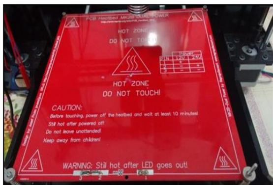
**Figura 4.** Mesa aquecida para deposição de material. **Fonte:** Os autores.
