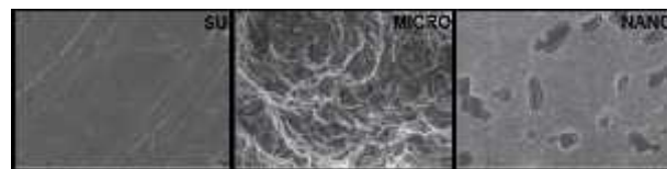
Figura 17. Imagens feitas pelo microscópio eletrônico de varredura (MEV) são três tipos de superfície de titânio: usinado (SU), jateado com alumina e posterior ataque ácido (MICRO) e anodizados (NANO) em aumento de 10000x. Fonte: Salou et al. (2015) 49 .
