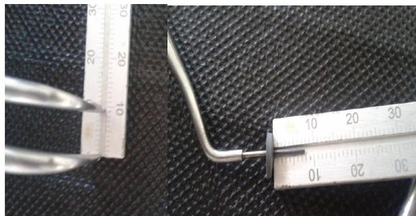
Figura 2. Medições realizadas para obter a forma do rebordo.
