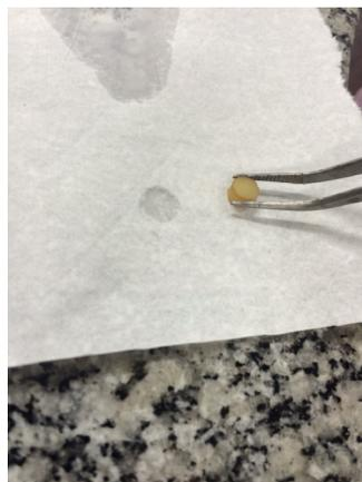
Figure 9. Corpos de prova secos em papel absorvente.
