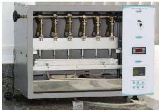
**Figura 6.** Ilustração frontal do equipamento eletromecânico de ensaios de fadiga por mastigação. (MSFM – ELQUIP, Equipments for Dental Research, São Carlos, SP, Brasil).
