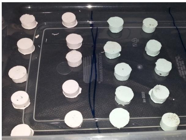
Figura 4. Corpos de prova na caixa seca.
