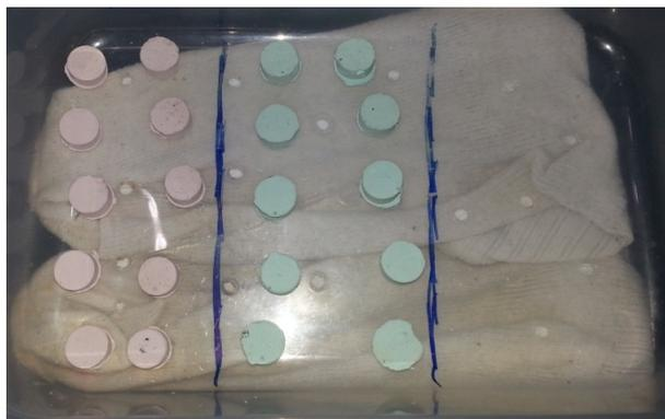
Figura 3. Corpos de prova na umidificadora.
