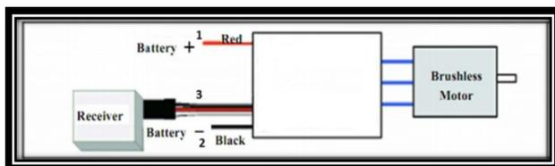
Figura 3. Esquema do ESC. Fonte: SILVA FILHO *et al.* 2011<sup>3</sup>.
