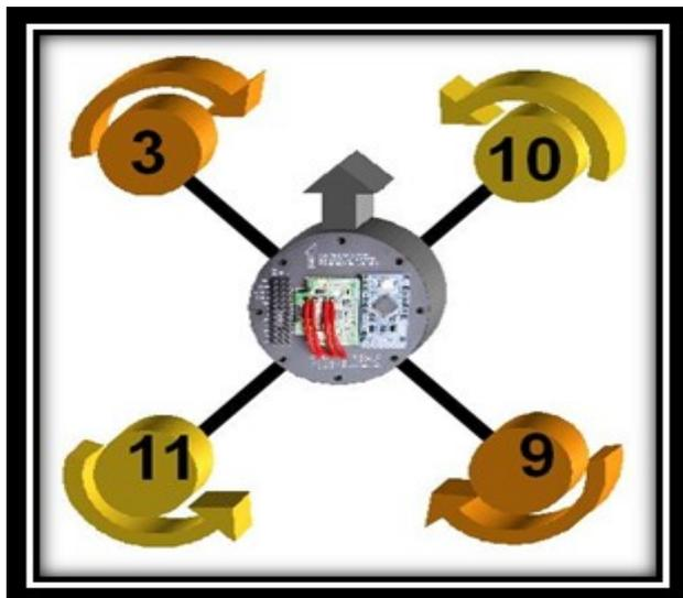
Figura 6. Sentido dos motores. Fonte: MultiWii<sup>4</sup>
