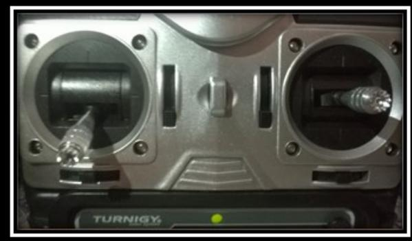
Figura 11. Botão esquerdo (acelerador e movimento rotacional), direito (para frente, para traz e para os lados).
