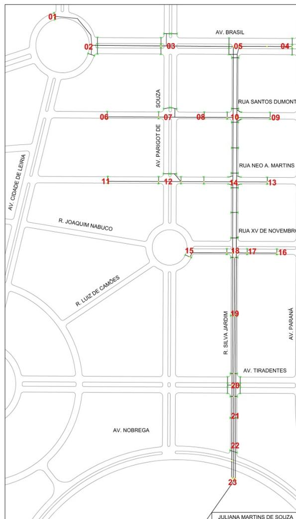
**Figura 3.** Traçado da rede galeria de águas pluviais existentes na região de estudo.
