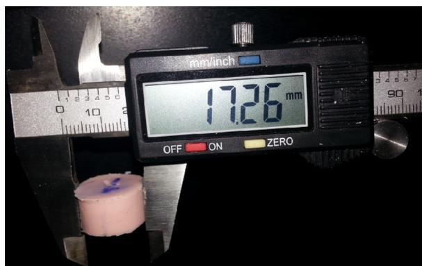
Figura 6. Corpo de prova sendo medido com paquímetro digital em circunferência).
