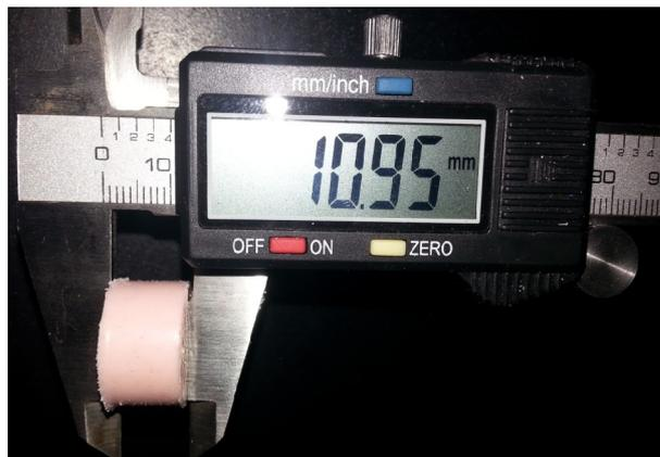
Figura 5. Corpo de prova sendo medido com paquímetro digital em altura
