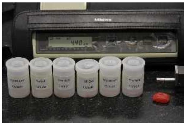
Figura 2. Rugosímetro SurfTest 301 (Mitutoyo – São Paulo, Brasil) para análise dos corpos de prova (cps).
